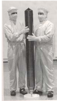
Abb. 1. Großer Monokristall mit einem Durchmesser von 10 cm und einer Länge von 100 cm. (Herstellung der Wafer-Technologie, hergestellt im Jahre 1958 für die IBM)
